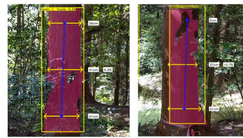
実施項目E 樹木の胸高直径の自動算出
