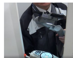
常閉防火扉のテンション測定
