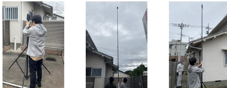
レーザースキャナによる点群測定と360度パノラマ写真の撮影
